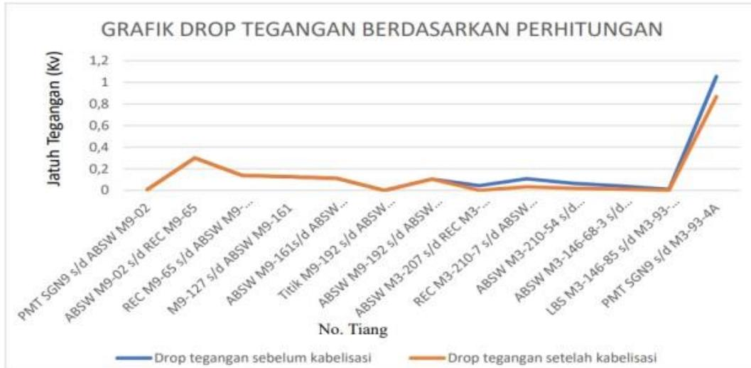
**Gambar 7.** Grafik Jatuh Tegangan Berdasarkan Perhitungan
