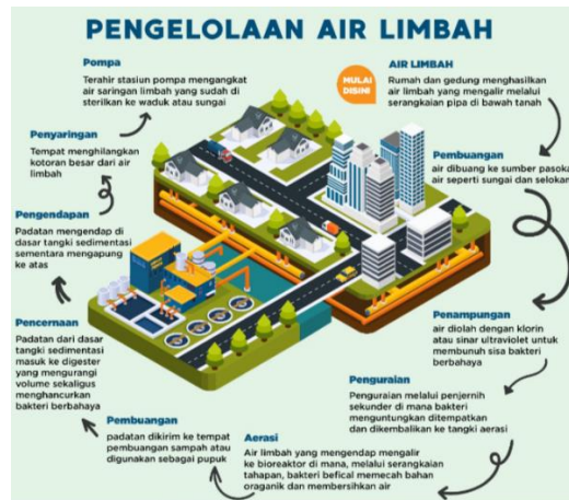
Gambar 4. Instalasi Pengelolaan Air Limbah (Dinas Sumber Daya Air Prov. Jakarta)
