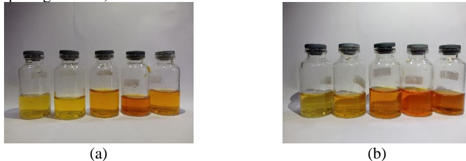
Gambar 5. Penyerapan zat warna metil jingga berdasarkan variasi konsentrasi pada karbon aktif (a) aktivasi dengan HCl (b) aktivasi dengan NaOH
