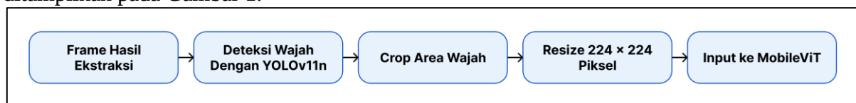
Gambar 1. Alur praproses deteksi wajah menggunakan YOLOv11n
