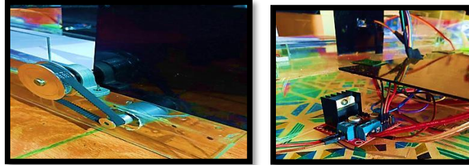
Gambar 5. Rangkaian Motor DC dan Driver L298N
