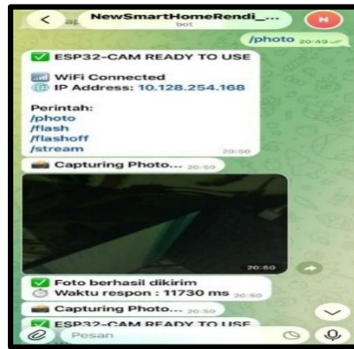
Gambar 2. perintah foto, flash , flashoff , link live streaming atau ip address
