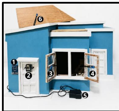
Gambar 6. tampak depan Implementasi SmartHome Security menggunakan Face Recognition & Sw-420 Vibrator Sensor.
