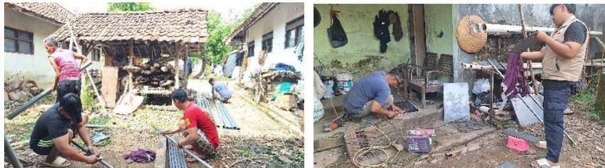
Gambar 4. Adalah proses kedua pemotongan dan pengelasan yang dilakukan di Bengkel Las Dusun Kawung Luwuk. Pengelasan dilakukan oleh ahli setempat dengan bantuan mahasiswa. Tahapan yang dilakukan meliputi pengukuran panjang dan lebar besi disesuaikan dengan desain yang telah dirancang. Proses pengelasan ini dilakukan menggunakan mesin las.
