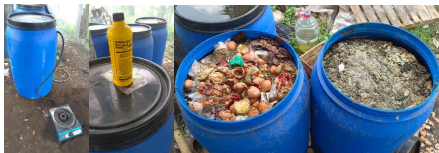
Gambar 2. Reaktor biogas untuk memproses sampah organik
